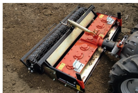
Réglage continu de la profondeur de travail à l'aide d'une tige
